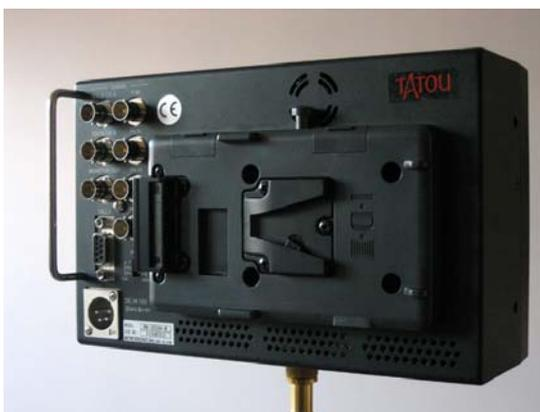
Un câble BNC permettait la liaison en HD-SDI de l'Astro à la caméra. Voilà à quoi se limitait notre matériel. Si on ajoute le trépied, le volume de cet ensemble reste tout à fait correct et permet d'assurer la mobilité que nous souhaitions avoir pour ce tournage.
